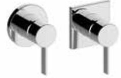
59551 Einhebelmischer UP DN 15 Mischwasserkartusche mit keramischen Dichtscheiben und Temperaturbegrenzung Fertigset bestehend aus: Hebel, Hülse, Rosette (rund oder eckig) und Funktionseinheit, passend für UP-Funktionseinheit Art.-Nr. 59551/000070
